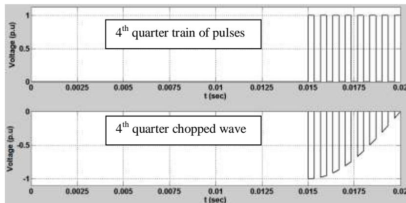
Fig. 1 (d) Developing of fourth quarter chopped wave
